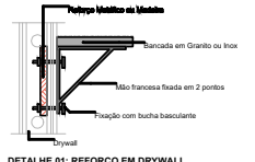
DETALHE B1: REFORÇO EM DRYWALL Escala: 1:20
